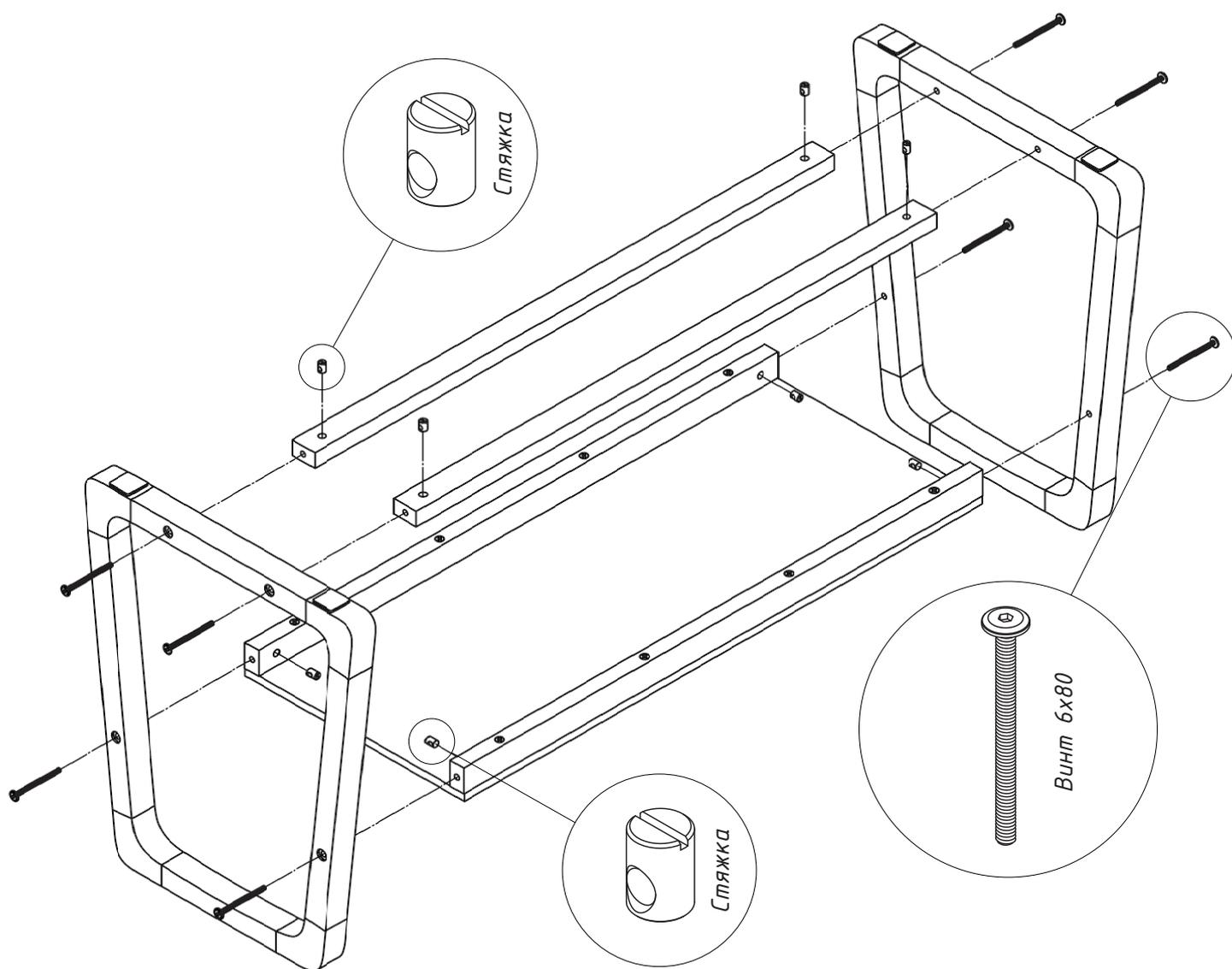
4. Установить в отверстия, в боковых поверхностях верхних царг, стяжки.
